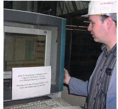
Bild 5: Michael Kreide von der Werkerhaltung bei Weso kann die kontinuierlichen Messwerte der Körperschallsensoren am PC überwachen
