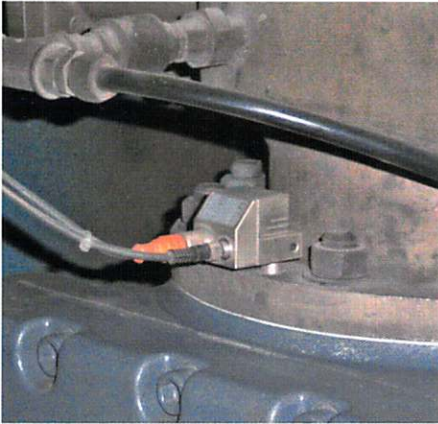
Bild 3: Die Körperschallsensoren erkennen, direkt an der Maschine angebracht Unwuchten und Lagerschäden an drehenden Bauteilen
